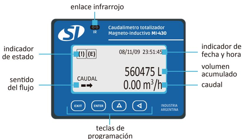
El uso de un caudalímetro electromagnético solamente se encuentra restringido por la condición del fluido conductor. La misma debe ser  $> 5$  (uS/cm).
