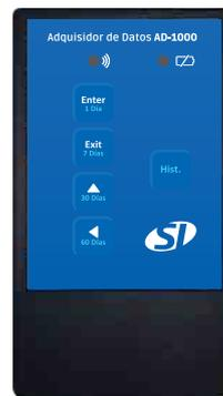
El AD-1000 permite, vía infrarroja, configurar el instrumento y relevar los valores historizados. Esto **evita conexiones cableadas o tener que contar con una notebook**.
